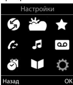
Функции главного меню отображаются на дисплее в виде значков. Значок выбранной функции выделен цветом, а ее название отображается в верхней строке дисплея.
