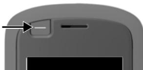
Клавише «Функции» можно назначить функцию по своему выбору (Быст.наб / LED-фонарик / Клавиша опов. /Клавиша отправ.).
